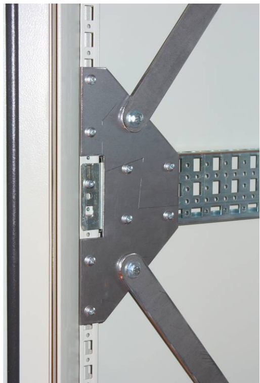
Рисунок 4, испытываемый шкаф, деталь жёсткого крепления
