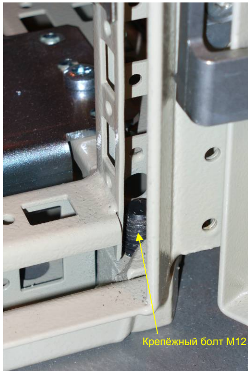
Рисунок 3, испытываемый шкаф, деталь крепления с зажимом основания
