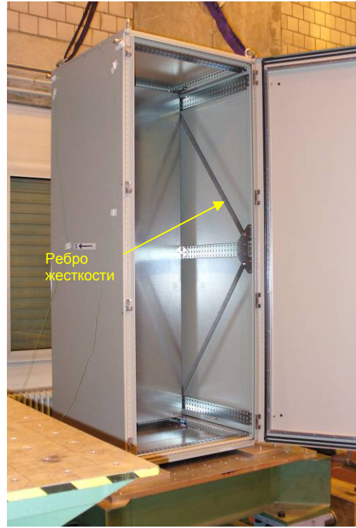
Рисунок 2, испытываемый шкаф, двери открыты
